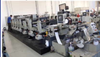
Letter Press Modelo SL 3022 Com 06 Estações de Impressão UV, mais uma para Verniz UV Com Corte Magnético.
